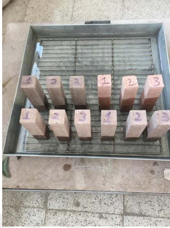
Şekil 3.14. Kılcal su emme deney düzeneği
