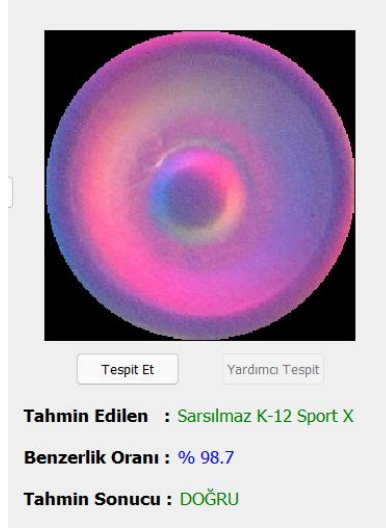
Şekil 9.32. Kapsülden Silah Tespiti Gerçekleştirilmesi
