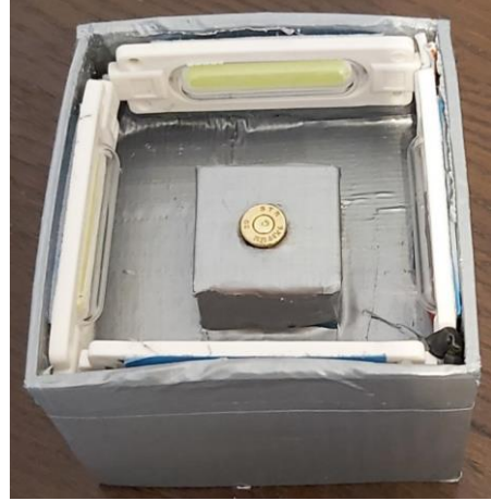
(b) Tezgâha Ait Tasarlanmış Işık Tertibatı
