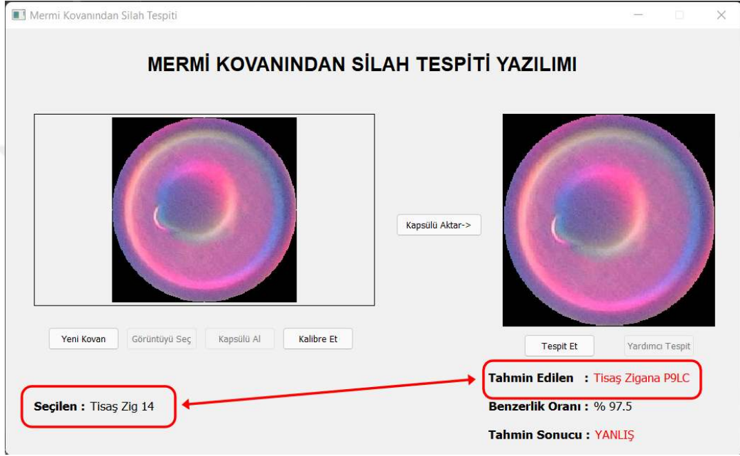
Şekil 9.34. Yanlış Silah Tespiti Durumu
