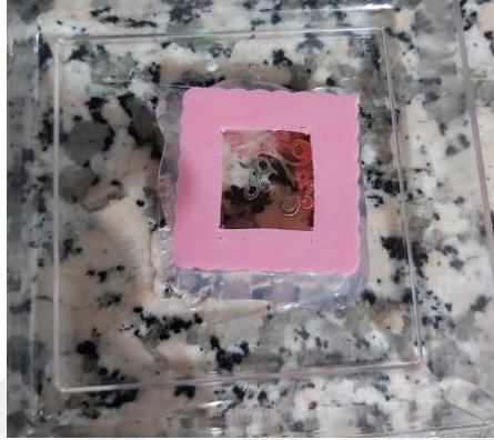
Şekil 9.15. Plastik Kap ile Camlı Elastomer Üretimi
