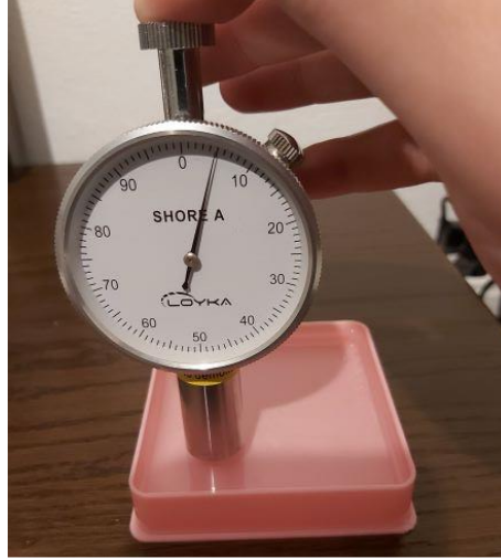
Şekil 9.8. Shore-A Ölçüm Cihazı ile Ölçüm Yapılması
