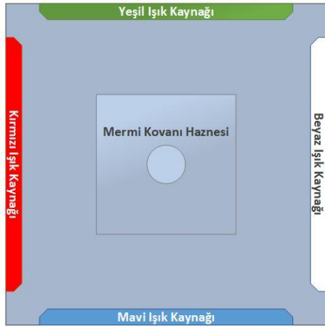
(a) Tezgâh için Işık Tertibatı Tasarımı
