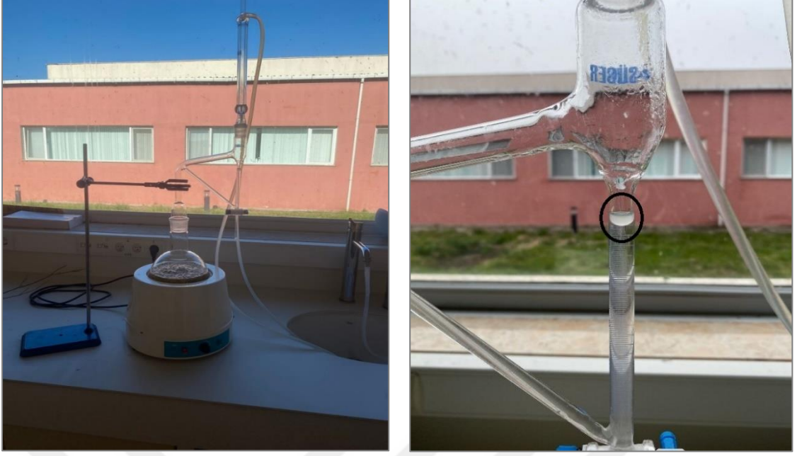
Şekil 2.2 Clevenger cihazı ile hidrodistilasyon ve biriken uçucu yağ
