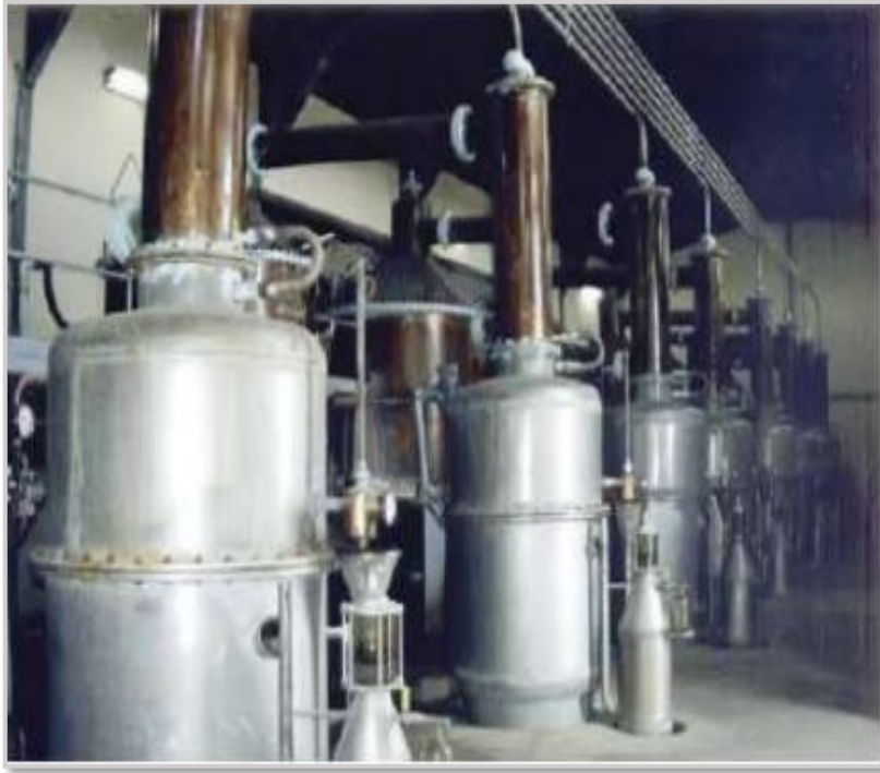
Şekil 1.2 Su distilasyonu ünitesi (Başer, 2010)
