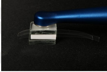
Şekil 3.2.2. Örneklerin hazırlanması ve VALO ışık cihazıyla polimerizasyon
