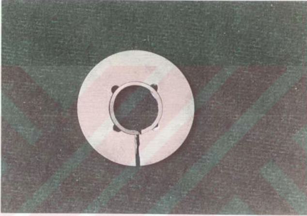
Resim 2: HEMA salınım örneklerinin elde edilmesinde kullanılan kalıp
