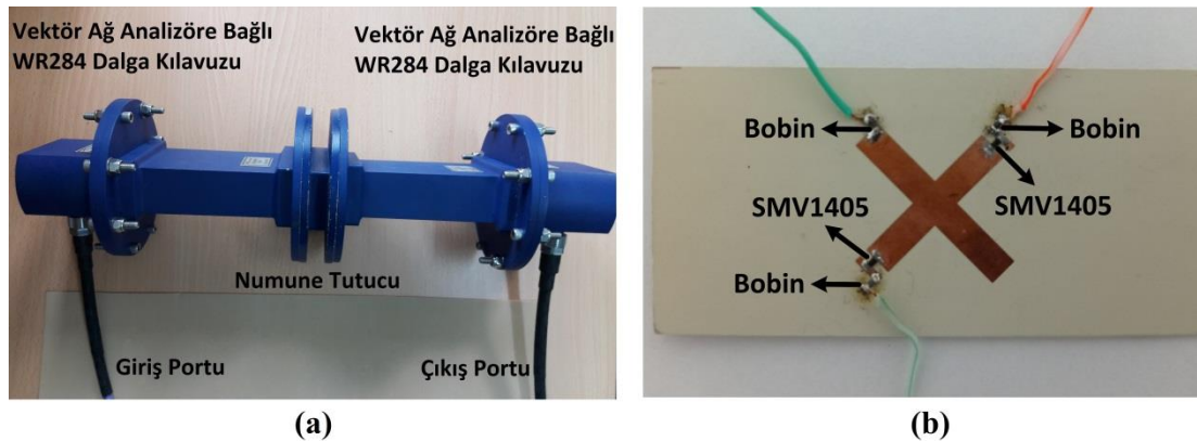
Şekil 4.68. Çift varaktör diyotlu soğurucunun a) ölçüm düzeneği; ve b) önden görünümü
