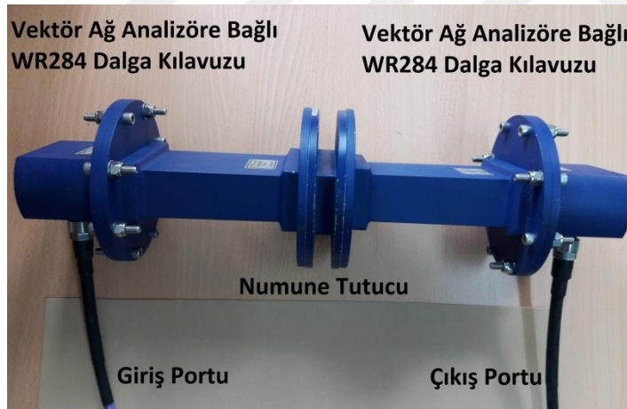
Şekil 4.24. YHR tabanlı soğurucunun ölçüm düzeneği
