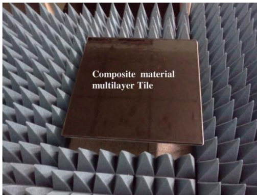
Şekil 1.2. Kompozit malzemeden oluşan çok katmanlı fayans (Micheli vd. 2011)
