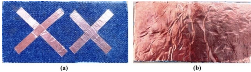
Şekil 4.47. Üretilen dört bantlı tekstil soğurucunun, a) önden görünümü; ve b) arkadan görünümü
