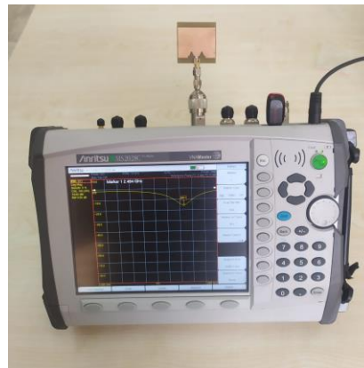
Şekil 7.75. Tasarlanan altıncı antenin network analizör sonuç görüntüsü
