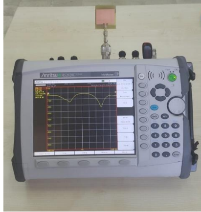
Şekil 7.76. Tasarlanan sekizinci çift bantlı antenin network analizör sonuç görüntüsü
