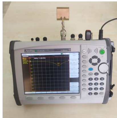
Şekil 7.75. Tasarlanan altıncı antenin network analizör sonuç görüntüsü
