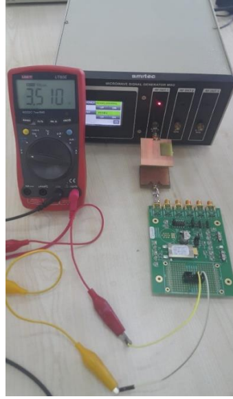
Şekil 7.78. Tasarlanan altıncı antenin 2.4 GHz’de gerilim sonucu
