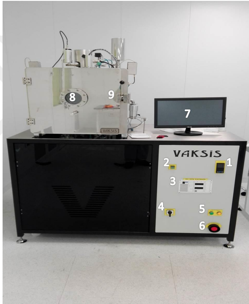
Şekil 3.1. Vaksis Saçtırma sistemi. 1. Altlık ısıtıcı PID kontrolcüsü 2. Bilgisayar açma/kapama butonu 3. DC güç kaynağı 4. Ana şalter 5. Başlatma durdurma butonları 6. Acil durdurma butonu 7. Kontrol ünitesinin monitörü 8. Plazma izleme penceresi 9. Kaplama odası
