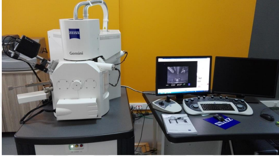
Şekil 3.18. Sigma 300 Model Zeiss Gemini marka FEG-SEM cihazı
