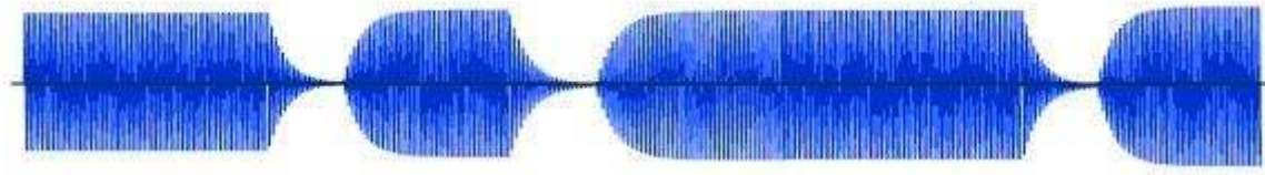
Şekil 7. Okuyucudan etikete veri iletiminde tipik işaret biçimi [4].
