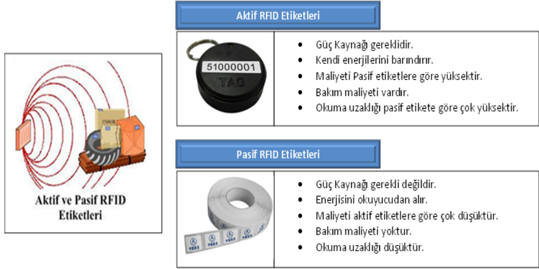
Şekil 2.3. Aktif-Pasif Etiket Karşılaştırma
