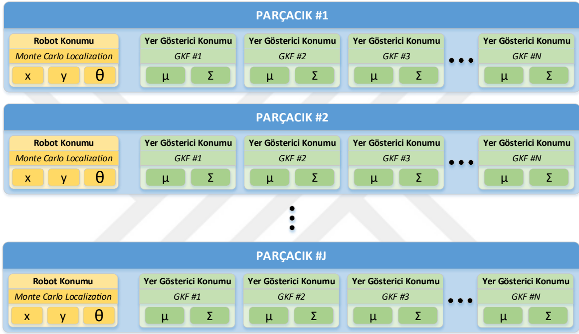
Şekil 2.5. FastSLAM algoritmasının yapısı (GKF: Genişletilmiş Kalman Filtresi)
