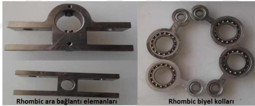
Resim 3.4 Rhombic biyel kolları ve ara bağlantı elemanları (Aksoy et al. 2016).
