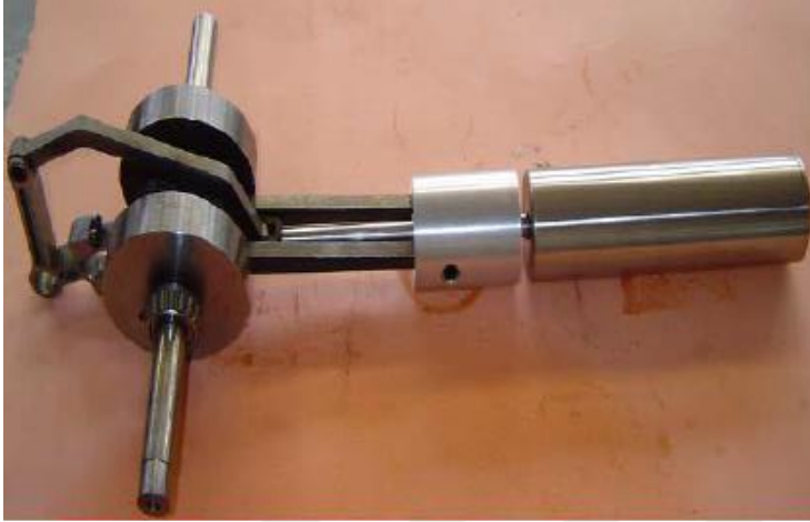
Resim 3.3. Manivela tip hareket mekanizmalı Stirling motoru [33]
