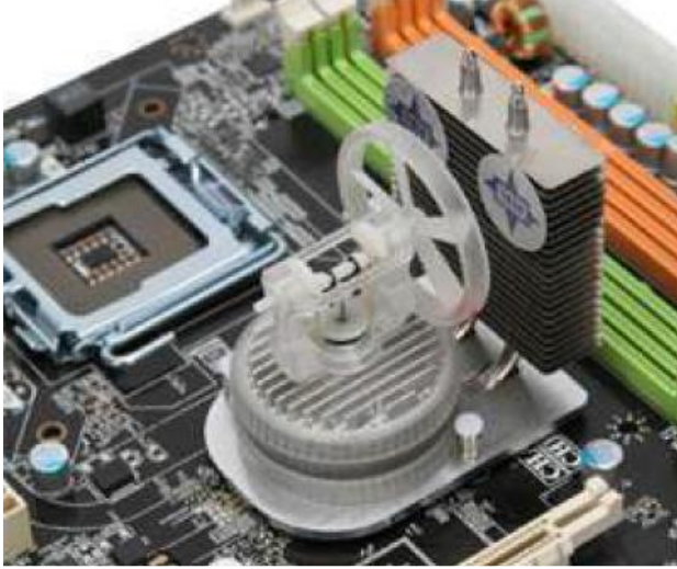
Resim 2.4. MSI firması tarafından kullanılan LTD Stirling motoru [1]
