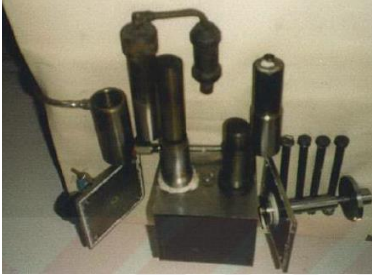
Resim 2.2. Demiralp tarafından üretilen gama tipi Stirling motoru ve parçaları [25]
