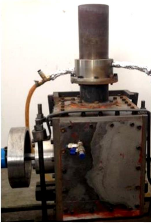
Resim 2.5. Karabulut ve arkadaşları tarafından üretilen beta tipi Stirling motoru [73]
