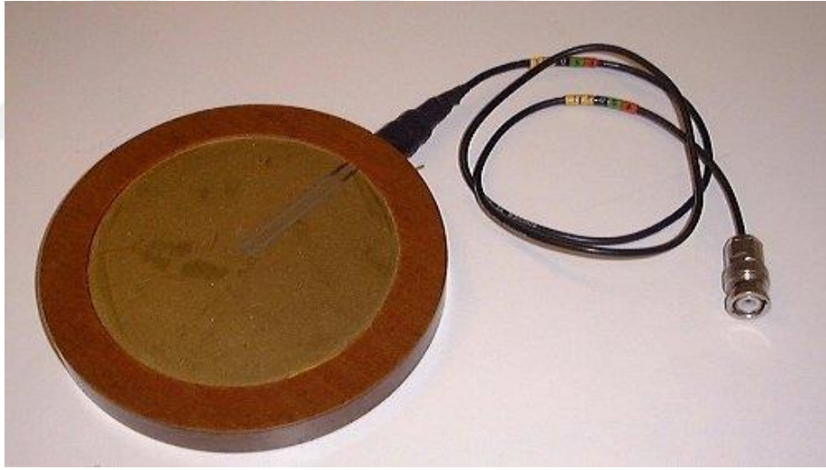
Şekil 5.14. Deney sisteminde kullanılan bilaminar zar tipi hidrofon
