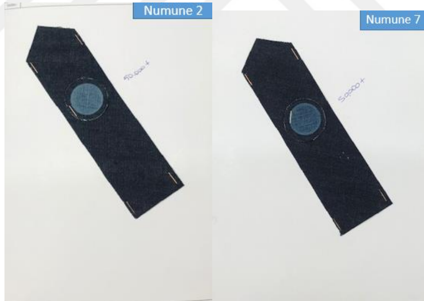
Şekil 4.36. KN2 ve KN7 mamul kumaşlarının ön yüzü aşınma dayanımı testi kartları
