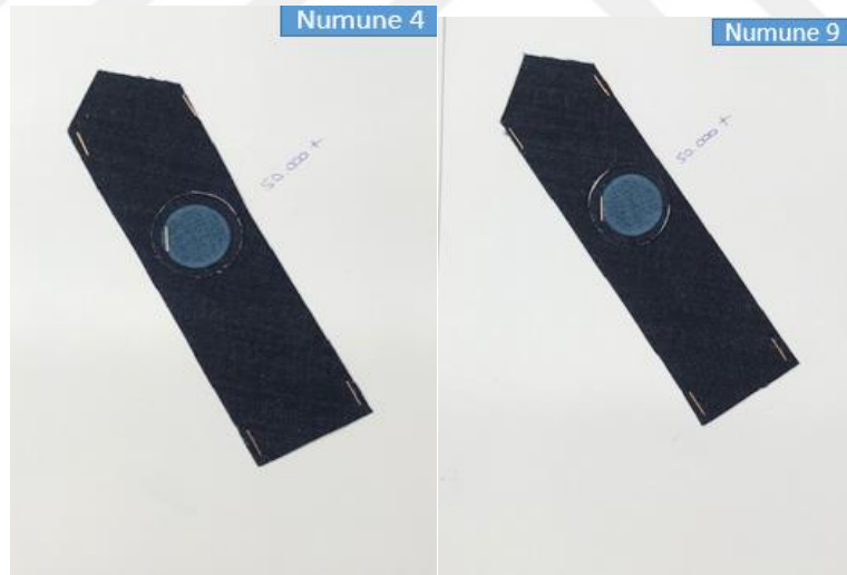
Şekil 4.38. KN4 ve KN9 mamul kumaşlarının ön yüzü aşınma dayanımı testi kartları
