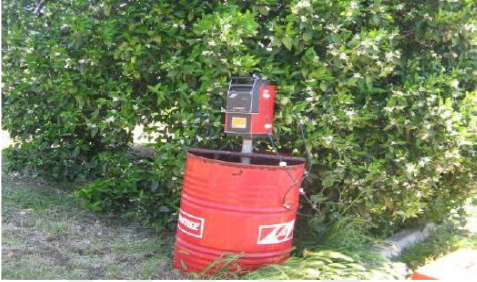
Şekil 3.4. Nötronmetre aletiyle standart okumalara ilişkin görüntü
