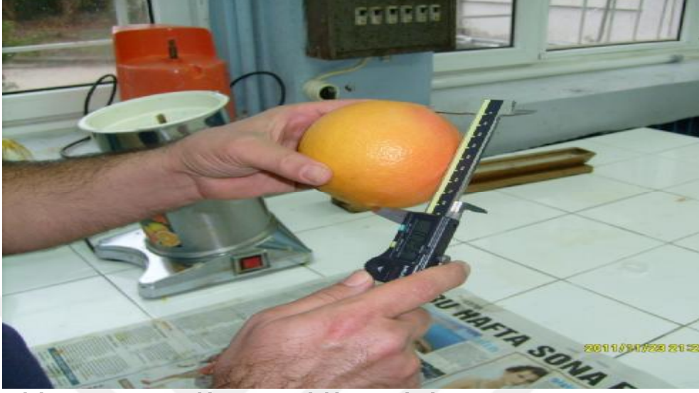
Şekil 3.10. Meyve örneklerinin uzunluklarının ölçülmesi
