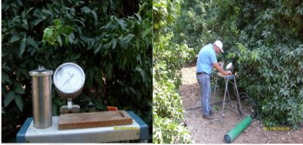
Şekil 3.6. Yaprak su potansiyeli (YSP) aleti ve YSP ölçümleri
