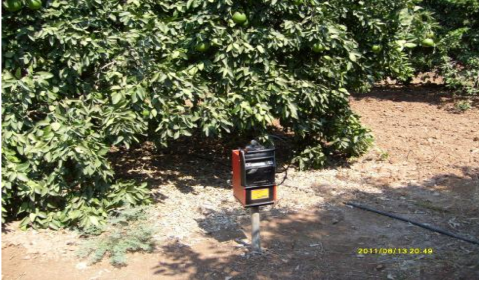
Şekil 3.3. Denemede kullanılan nötronmetre aleti
