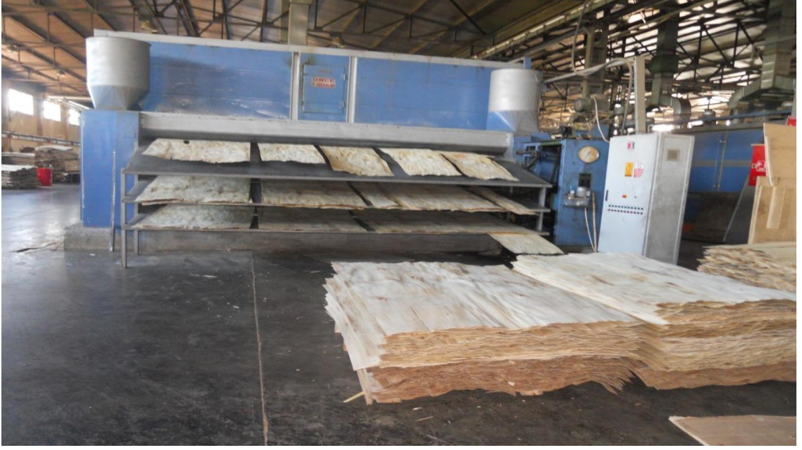
Şekil 5: Kurutma fırınından çıkarılan kaplamalar.
