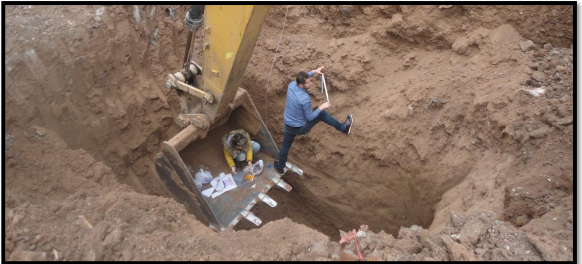
Şekil 5.17. Babil ve Serhat Apartmanları arasında kalan sahada açılmış olan araştırma çukuru açılma sırasındaki arazi çalışmaları
