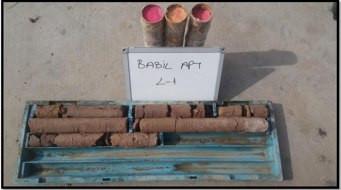
Şekil 5.6. Babil Apartmanında açılan L-1 numaralı sondaj kuyusundan alınan örnekler
