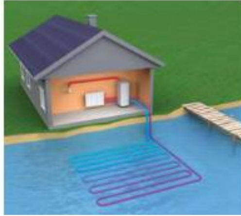
Şekil 11. Su kaynaklı ısı pompası sistemi
