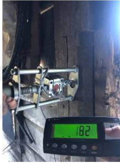
Şekil 28. Vida tutma direnci ölçüm cihazı (Aydoğan Selçuk, 2021)
