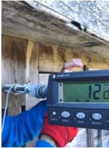
Şekil 11. Vida tutma direnci ölçüm aparatı (Aydoğan Selçuk, 2023)
