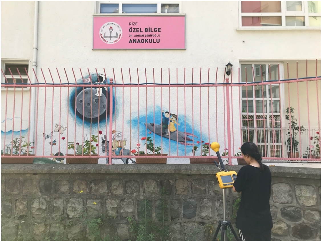
Şekil 23. Bilge Anaokulu'nda SRM 3006 cihazı ile ölçüm örneği
