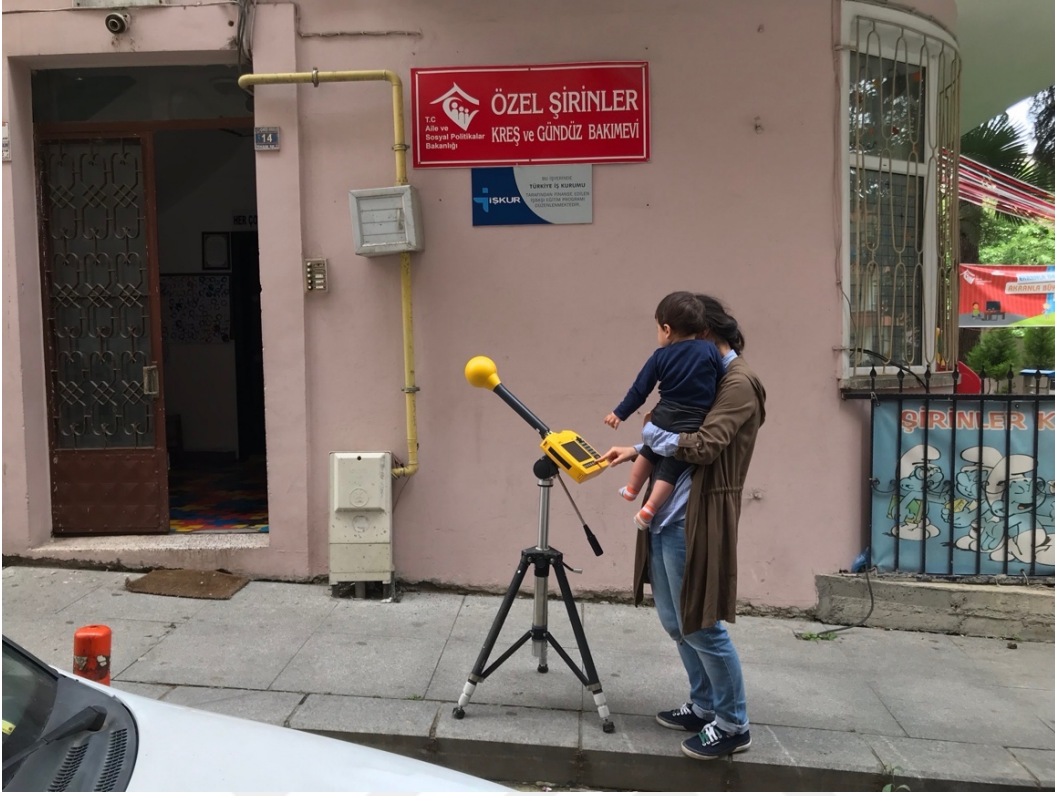
Şekil 24.Şirinler Gündüz Bakımevi'nde SRM 3006 cihazı ile ölçüm örneği
