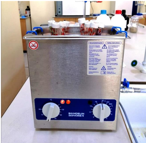
Şekil 8. Ultrasonik banyo ile ekstraksiyon işlemi
