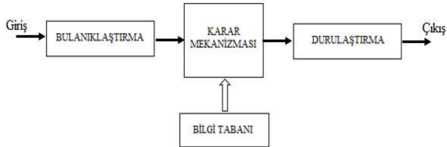
Şekil 4.5. Bulanık Mantık Denetleyici temel yapısı [50]
