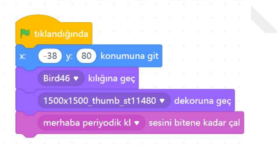
Şekil 3.13. Ses bloğu eklenmesi
