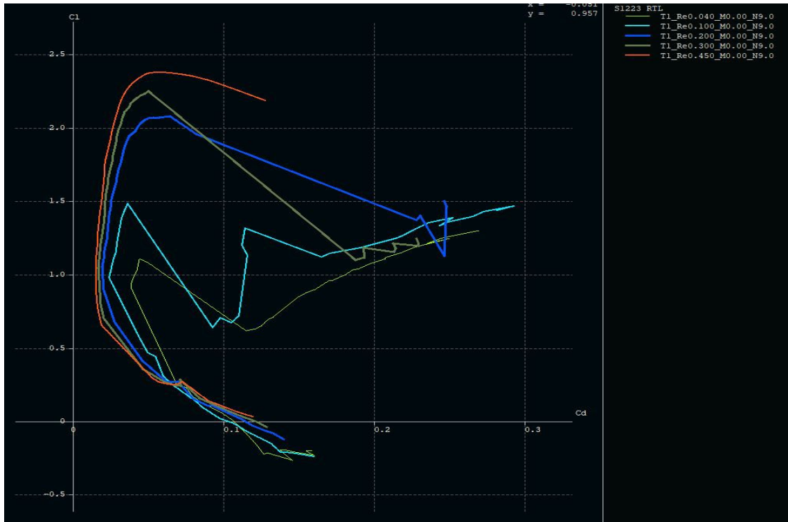
Şekil 4.4 Taşıma- Sürüklenme katsayısı grafiği
