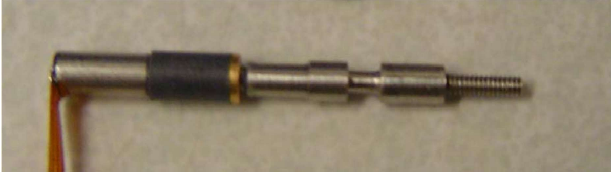
Şekil 1.51: DC motor, konektör ve vidadan oluşan doğrusal bir eyleyici.
