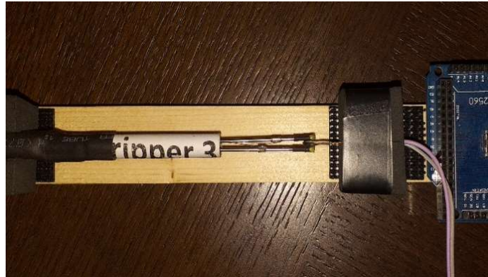
Şekil 4.2: Tutucu 3 uçlarının Kuvvete Duyarlı Sensor (KDS) yardımı ile basma kuvveti ölçümü.
