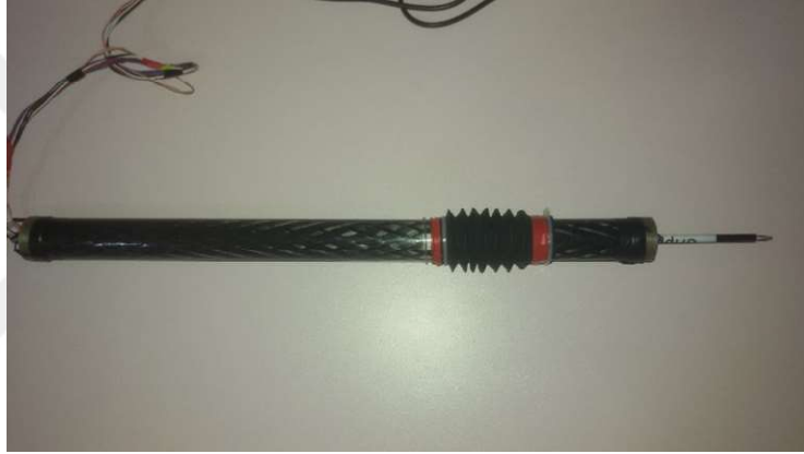
Şekil 2.4: Şekil hafızalı alaşım teller ile kontrol edilen iki serbestlik derecesine sahip kol tasarımı.
