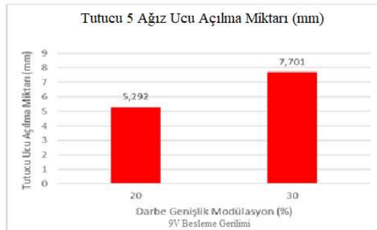
Şekil 15: 100 Hz sabit frekans değeri, 9V Besleme geriliminde Tutucu 5'e ait tutucu uçların açılma miktarı.
