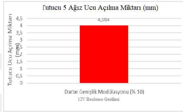
Şekil 17: 100 Hz sabit frekans değeri, 12V Besleme geriliminde Tutucu 5'e ait tutucu uçların açılma miktarı.
