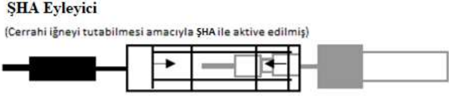
Şekil 1.55: Tutma eyleminin devamlılığının ŞBA teller ile sağlandığı ikinci aşama.
