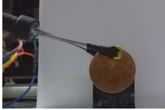
Şekil 5.7: Tutucu 8'in tutma kaldırma performansı (3.92gr).
