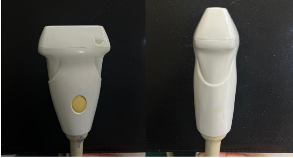
Şekil 3.2 USG cihazı E-SAOTE Bio-Sound MY LAB Lineer Probu
