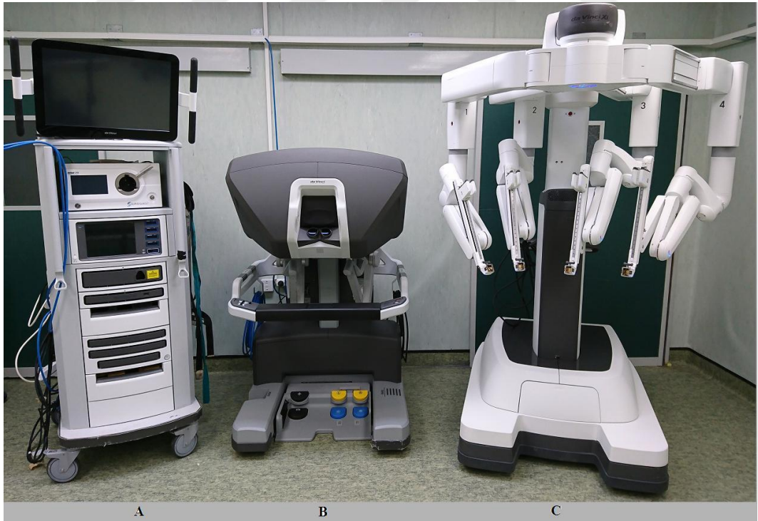
Şekil 2.2. Da Vinci® Xi™ 2014 robotik cerrahi sistemi (A: Konsol ile robotik kollar arasında bağlantı yapan kule, B: Cerrahin operasyonu yönettiği konsol, C: Robotik kollar)
