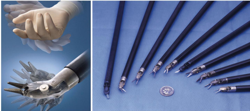
Şekil 2.3. da Vinci® sistemine ait çeşitli robotik kollar ve el bilek hareketine benzer hareketi (4).
