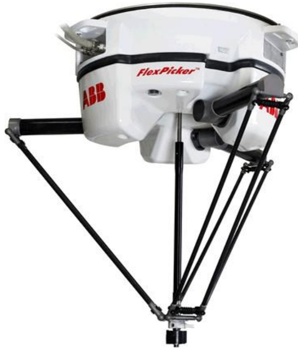
Şekil 5.5. Delta Robot Ticari Tasarımı (Williams II, 2016)
