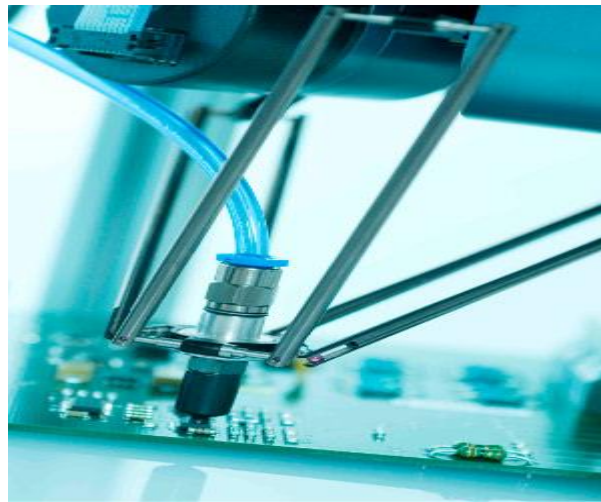
Şekil 4.15. Elektronik Devre Kartı Hazırlayan Delta Robot (Anonim, 2013b)
