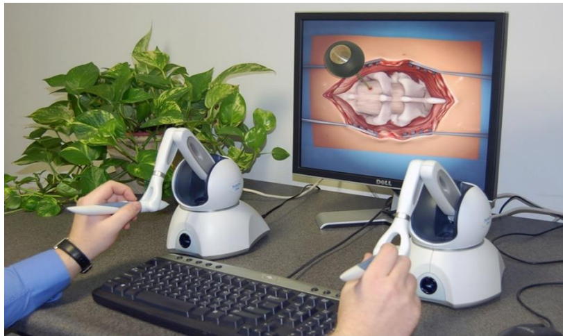
Şekil 3.27. Doktor Adayları İçin Yapılan Haptik Sistem Simülasyonu (Anonim, 2018e)
