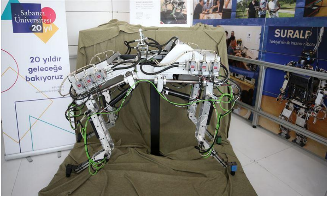
Şekil 3.17. Dört Bacaklı Hidrolik Robot (Alyanak, 2019)
