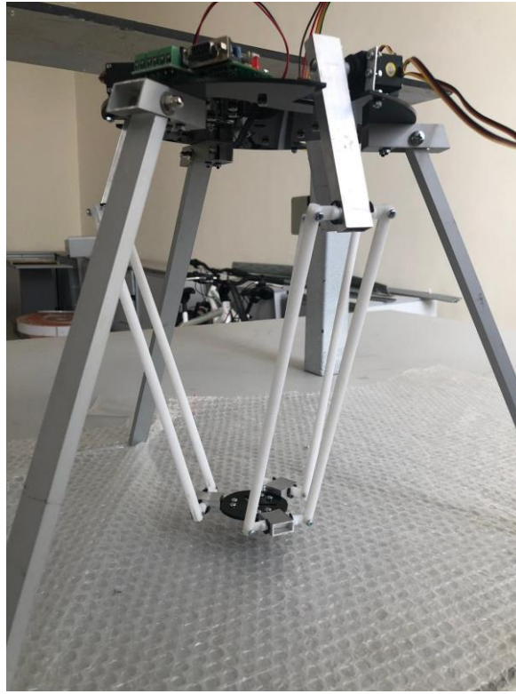
Şekil 6.1. Prototipi Gerçekleştirilen Delta Robot
