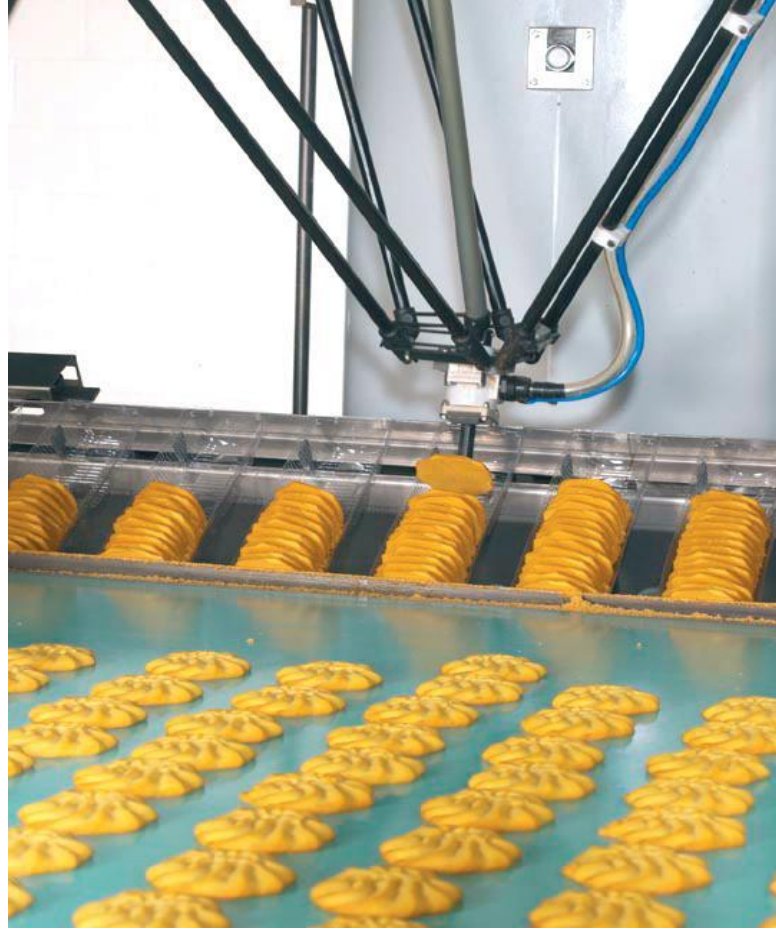
Şekil 4.13. Paketleme Yapan Delta Robot (Anonim, 2013b)
