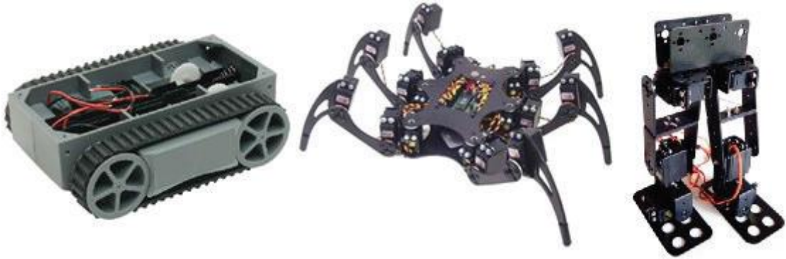
Şekil 3.36. Paletli ve Ayaklı Mekanik Bileşen Örnekleri (Çolak, 2019)
