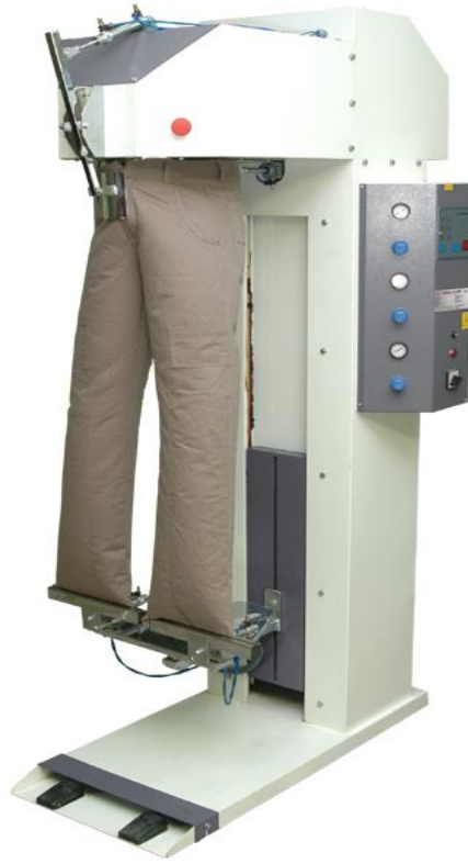
Şekil 3.16. Pnömatik Pantolon Şişirme Robotu (Anonim, 2019e)
