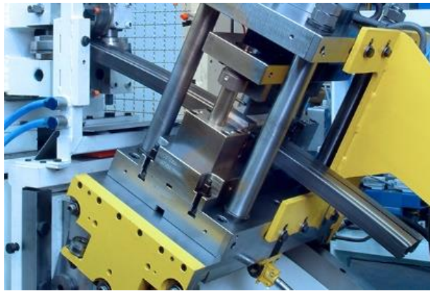
Şekil 2.2 : Çarpışma tamponuna rollform sonrası sehim verme operasyonu
