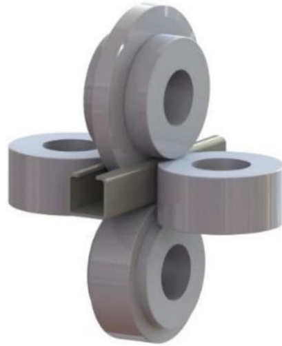
Şekil 3.10 : Alt, üst, sol ve sağ makaralarla ilgili örnek bir görsel [15]
