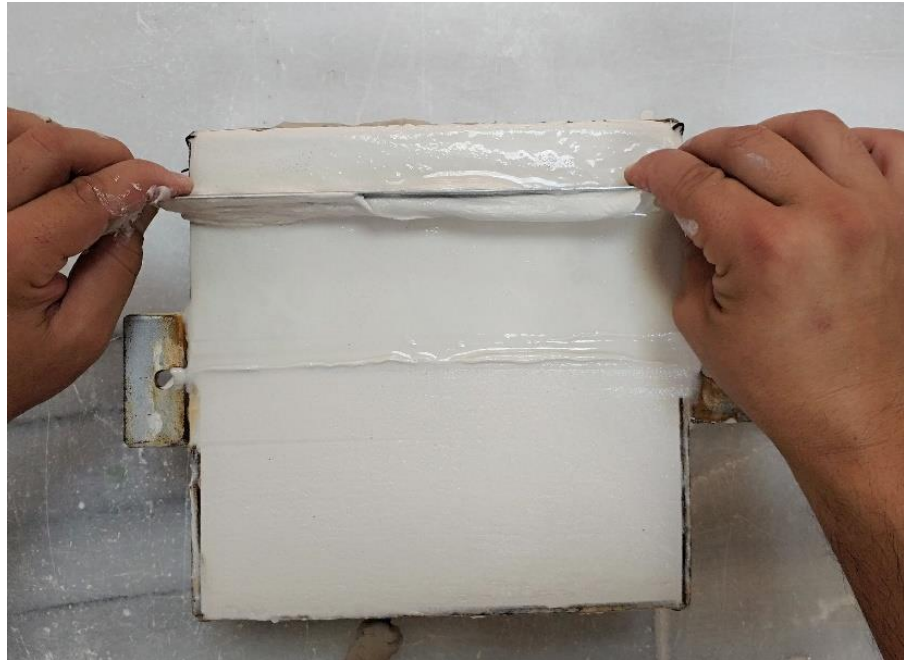
Görsel 67: Kalıbın Yüzeyinin Masterla Sıyrılması
