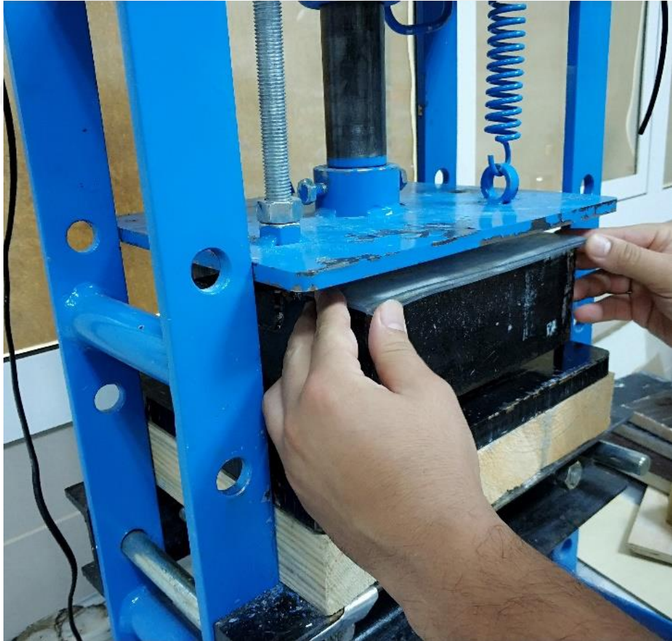
Görsel 69: Boşluk Kontrolü ve Kauçuk Plakanın Yerleştirilmesi
