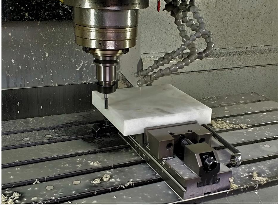
Görsel 55: Polietilen Parçanın Tablaya Yerleştirilmesi ve Koordinatlarının Sıfırlanması
