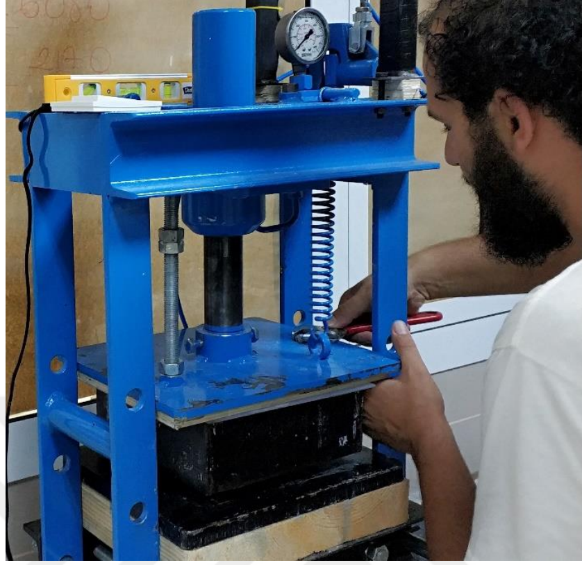
Görsel 70: Kalıbın Tablaya Cıvata Yardımıyla Bağlanması
