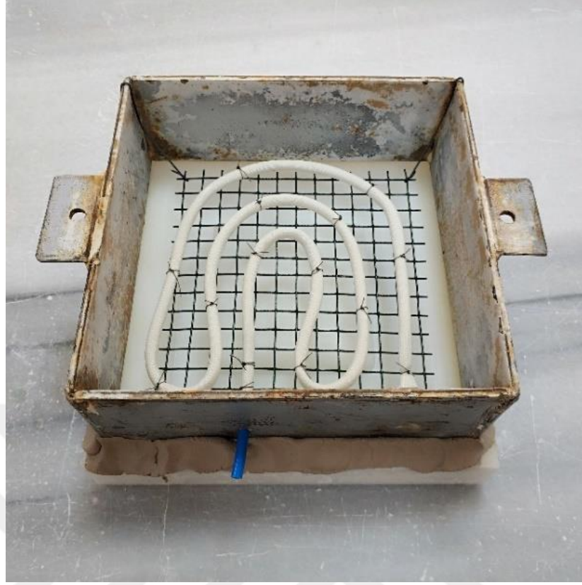
Görsel 63: Hortum Sisteminin Kalıp Demirine Sabitlenmesi
