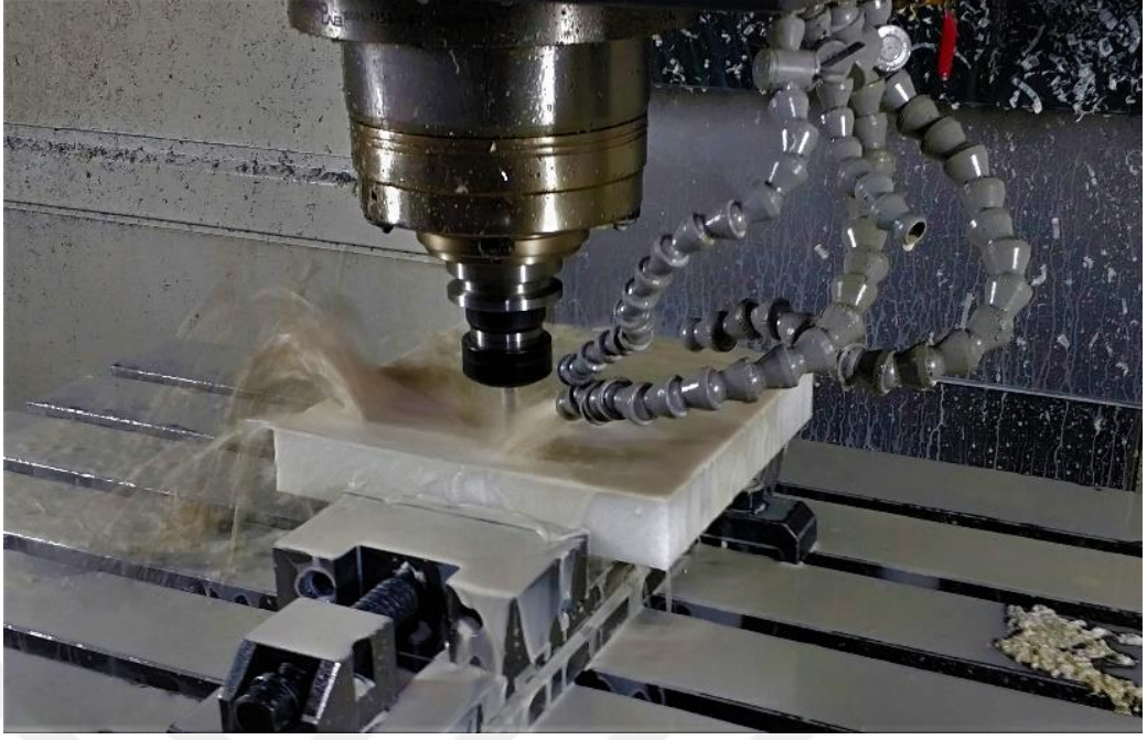
Görsel 56: Modelin Kaba İşleme Aşaması ve Soğutma Sistemi
