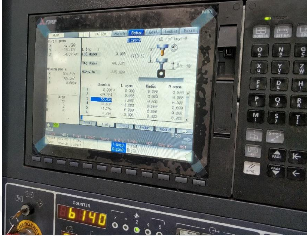
Görsel 54: Modellerin İşleneceği CNC'nin Bilgisayarlı Kontrol Ünitesi
