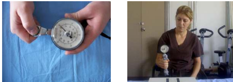
Şekil 6: Pinçmetre ve El Dinamometresi (JAMAR)
