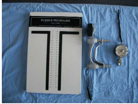
Şekil 8: Sırasıyla Purdue Pegboard, El dinamometresi (JAMAR), Pinçmetre
