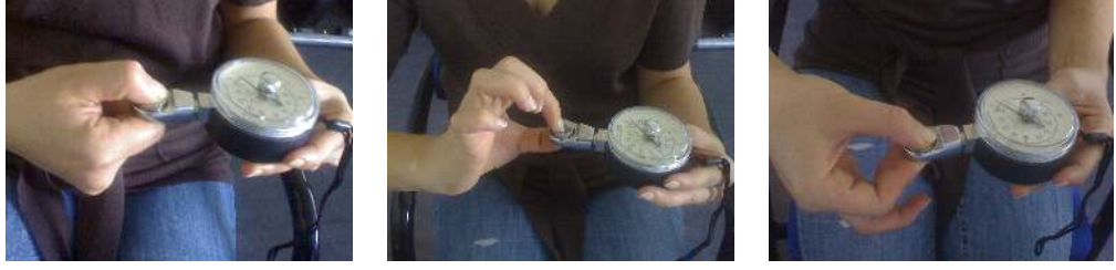
Şekil 7: Sırasıyla lateral, parmak ucu ve üç parmak kavrama gücü ölçümleri
