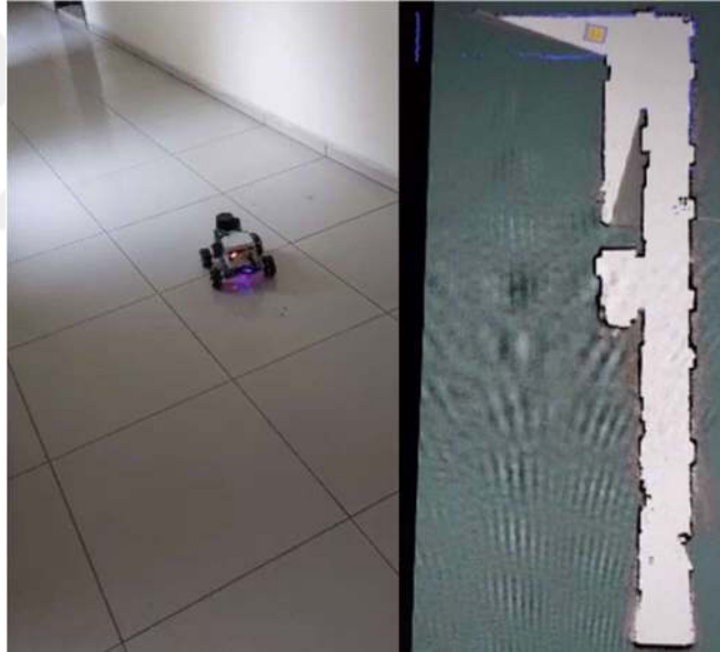
Şekil 5.23 : Gerçek robot ile haritalamada yeni koridora giriş.
