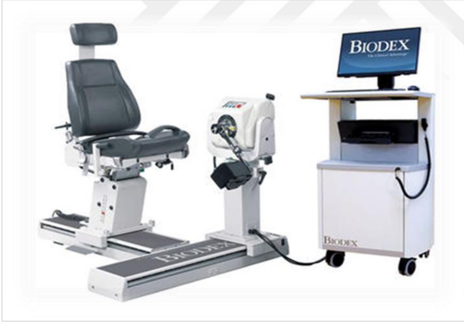
Resim 3.5. Kas kuvvetinin değerlendirilmesi için izokinetik bilgisayar destekli dinamometre
