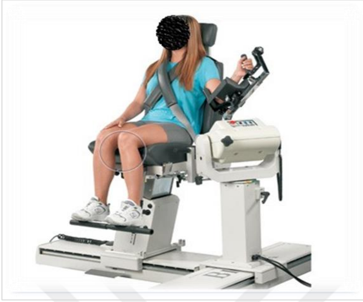
Resim 3.6. İzokinetik kuvvet ölçümünde dinamometre ile kişinin pozisyonlanması
