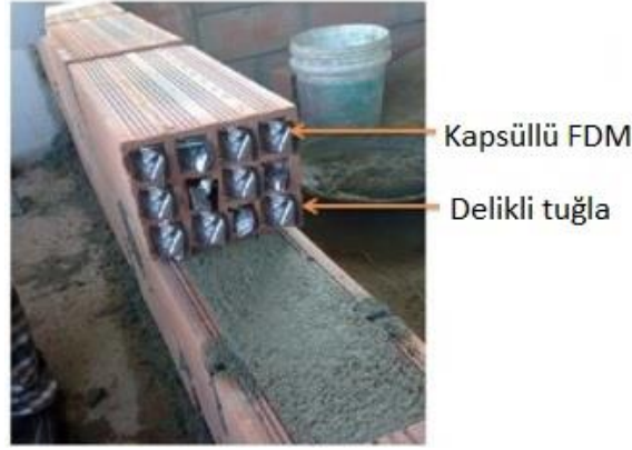
Şekil 2.2. Kapsüllü faz değıştiren malzeme (FDM) ile doldurulmuş delikli tuğla
