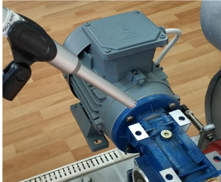
Şekil 8. Akustik ölçümüne dayalı kestirimci bakım deney düzeneği (Karabacak vd., 2022)
