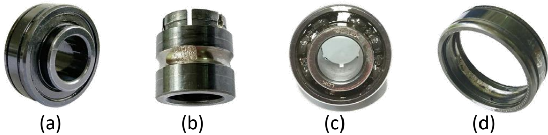
Şekil 23. Normal ve bozulmuş rulman fotoğrafları (a) Normal, (b) İç bilezik hatası, (c) Kafes hatası, (d) Dış bilezik hatası (Wang, 2018)
