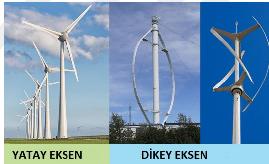
Şekil 1.7. Yatay ve Dikey Eksenli Rüzgar Türbinleri (Url-12)
