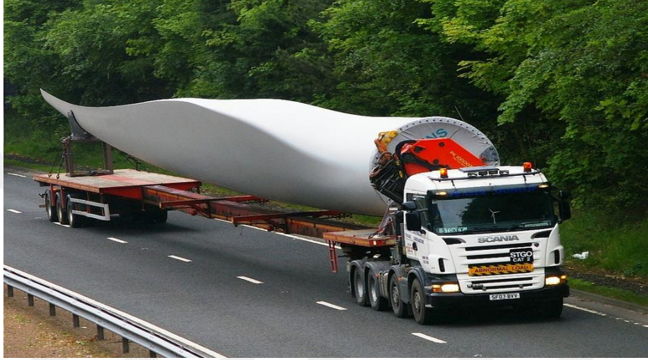
Şekil 1.13. Rüzgâr türbini parçalarının santral alanına taşınması (Url-13)
