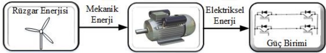
Şekil 2.1. RES'lerde enerji dönüşümü
