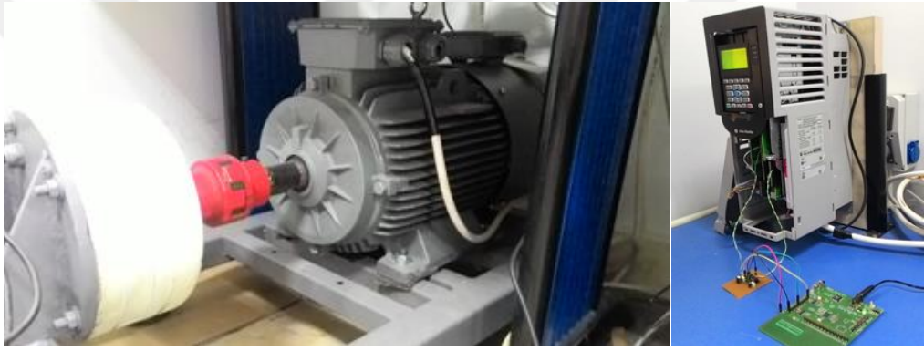
Şekil 6.3. Asenkron motor, SMSG, sayısal işlemci ve AC hız sınırlamalı sürücü
