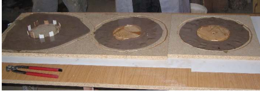
Resim 4.13. Polyester reçinenin kalıplara dökülmüş hali
