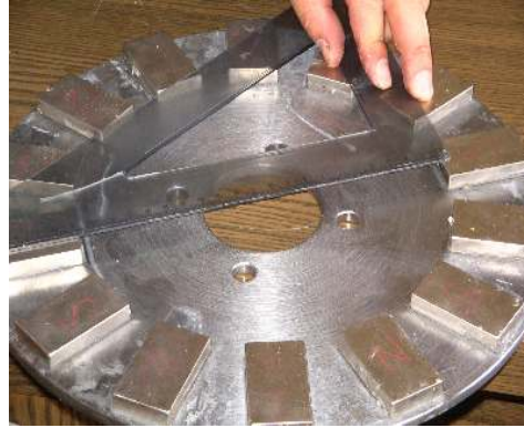
Resim 4.6. Rotor nüvesi üzerine yapıştırılan mıknatıs bloklarının görünüşü
