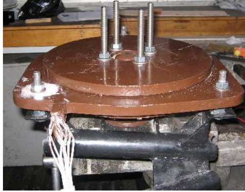
Resim 4.19. Stator ve rotorların birleştirilmiş hali
