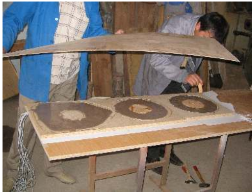
Resim 4.14. Kalıpların üzerinin kapatılması
