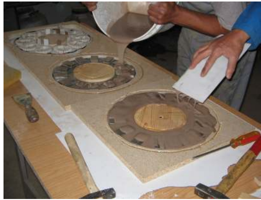
Resim 4.12. Polyester reinenin kalıplara dökölmesi
