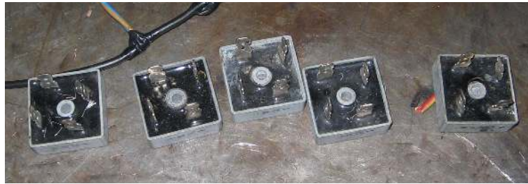
Resim 4.21. Tek fazlı köprü doğrultucular (35 A, 600V)
