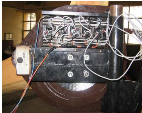
Resim 4.22. Köprü doğrultucuların alüminyum soğutucu üzerine monte edilmesi
