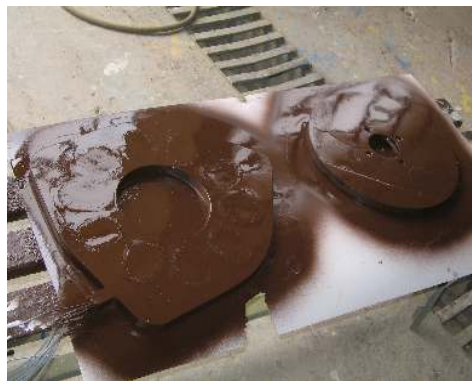
Resim 4.18. Boyanmıř rotor ve stator
