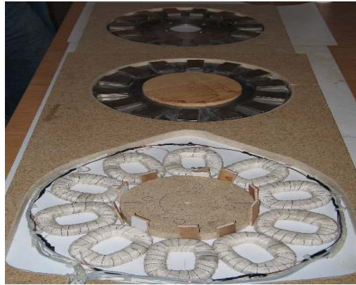
Resim 4.10. Kalıpları hazırlanan rotor ve stator
