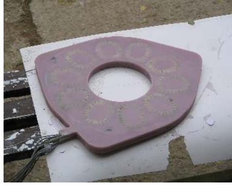
Resim 4.16. Kalıptan çıkarılan stator
