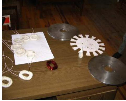
Resim 4.5. Rotor nüvesi, yardımcı kalıp ve bobinlerin görünüşü
