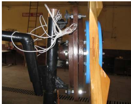
Resim 4.20. Stator ve rotorların porye ve kanatlara bağlanmış şekli
