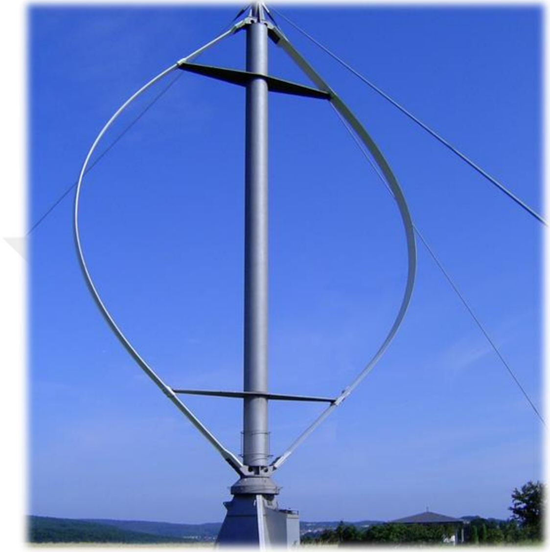
Şekil.3.3. Darrieus tipi düşey eksenli rüzgâr türbini [52]
