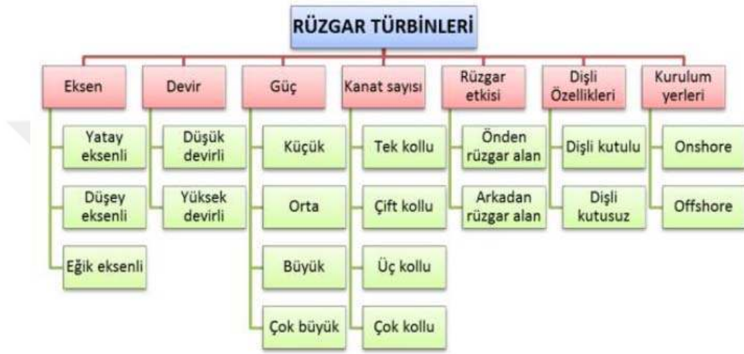
Şekil 4.1. Rüzgar türbinlerinin sınıflandırılması (Elibüyük ve Üçgül)
