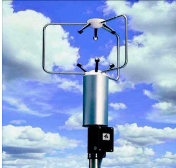
Şekil 3.4. Ultrasonik Anemometre (Golding, 1976)
