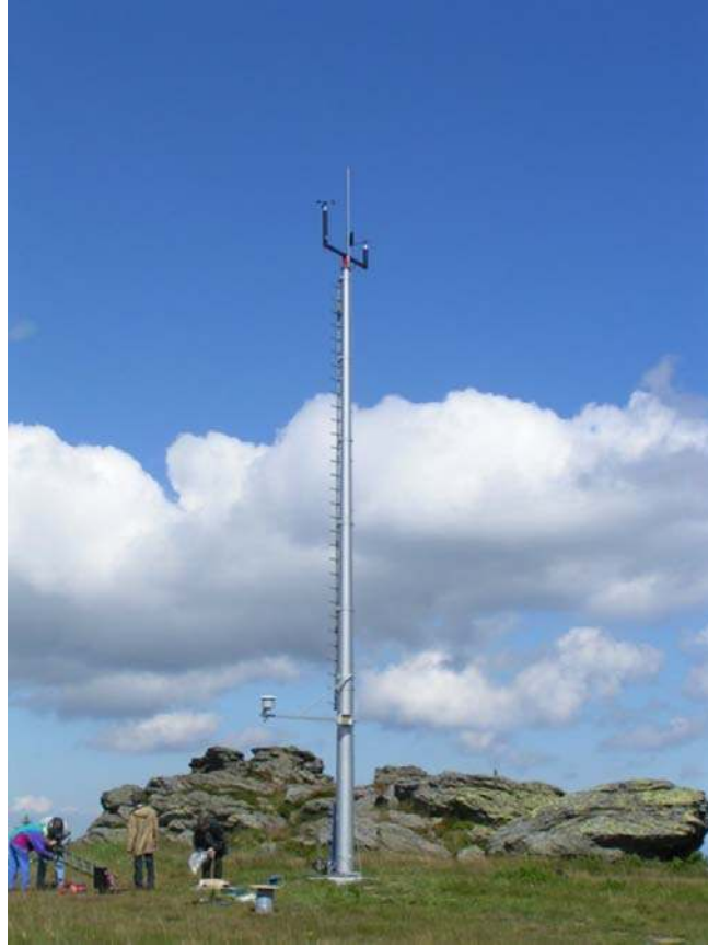
Şekil 3.1. Rüzgar Ölçüm İstasyonu (Leung ve ark., 2012)
