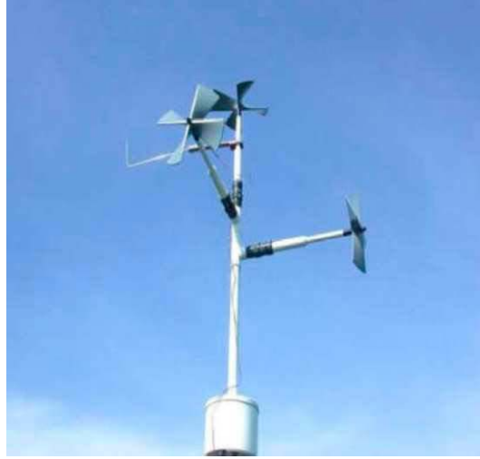
Şekil 3.3. Pervaneli Anémomètre (Çolak ve ark., 2015).
