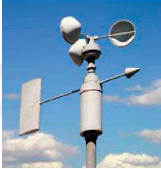
Şekil 3.2. Kepçe Anemometre (Çolak ve ark., 2015).
