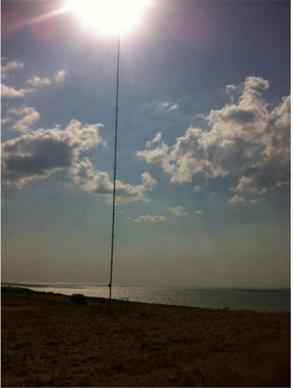
Şekil 2.3 Analiz edilen verilerin elde edildiği rüzgar ölçüm direği
