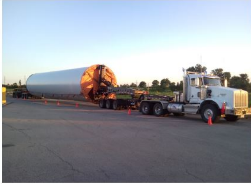
Şekil 6.1 : Çelik malzemeden üretilmiş kule segmentinin nakliyesi.
