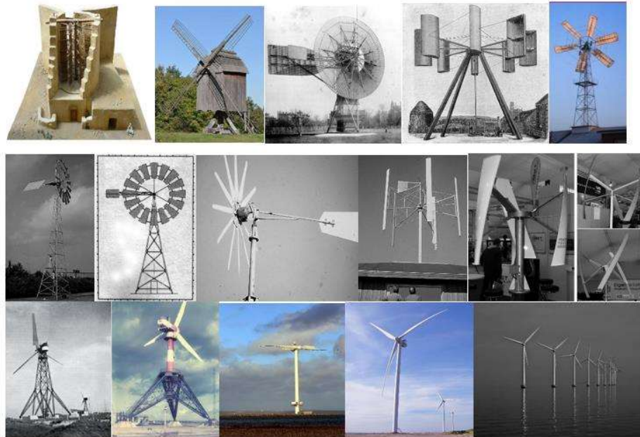
Görsel 3.1. Zamanla rüzgâr türbini şekillerinin gelişimini (Jackson, 2013).
