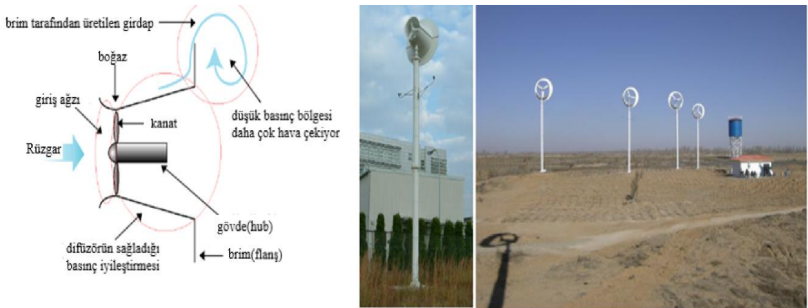
Şekil 18. Difüzörün rüzgar türbinine etkisi deneyi (Ohya & Kradusani, 2010)
