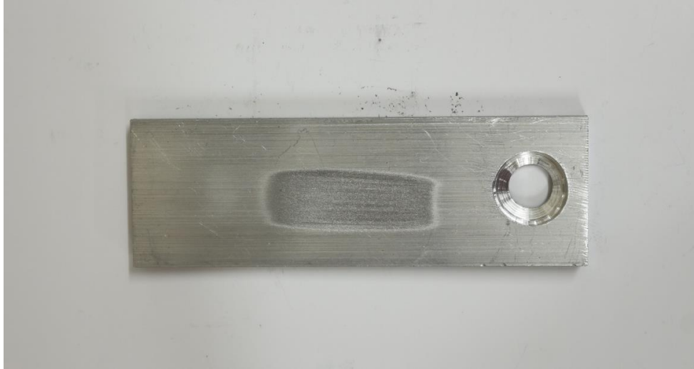
Şekil 29: RWAT testi sonrası aşınmış numune yüzeyi.
