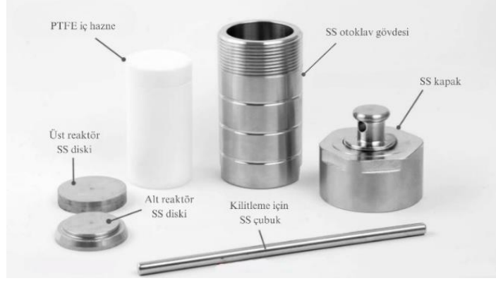
Şekil 1.7. Hidro/Solvotermal sentez reaktörü.
