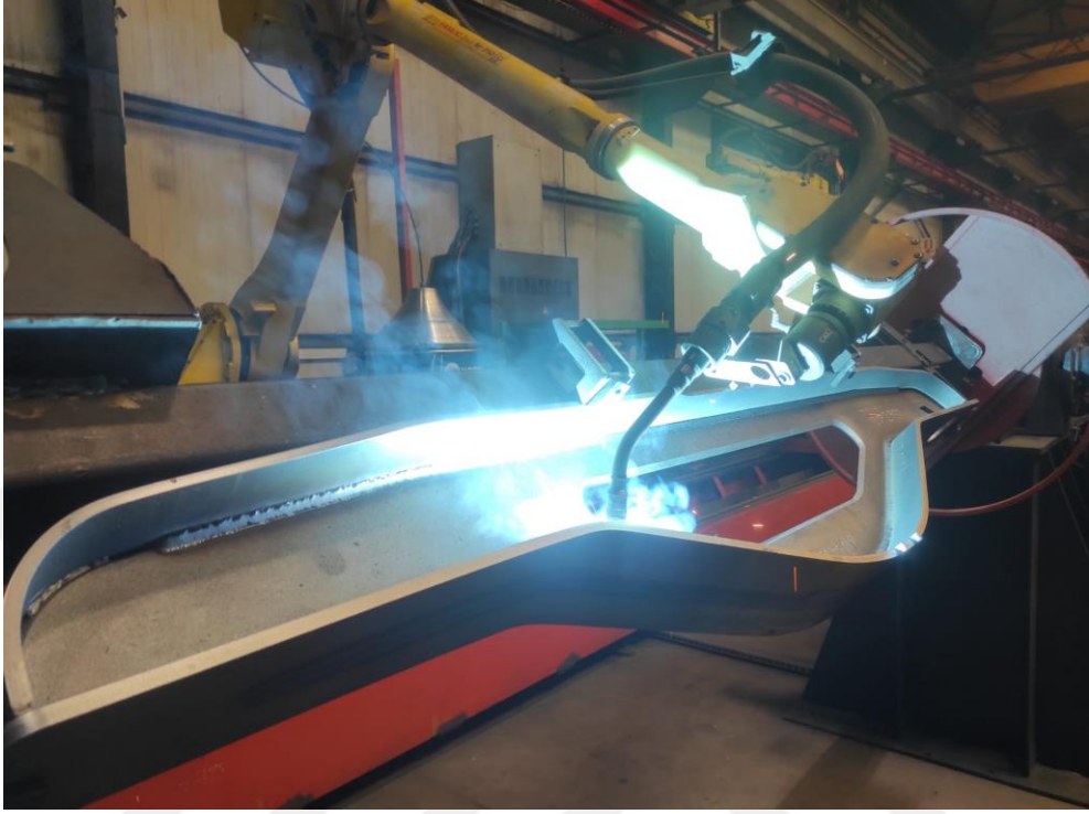
Şekil 6-4 : Robotik Kaynak Makinasının Fabrika İçinde Seri Kaynaklı İmalat Aşaması
