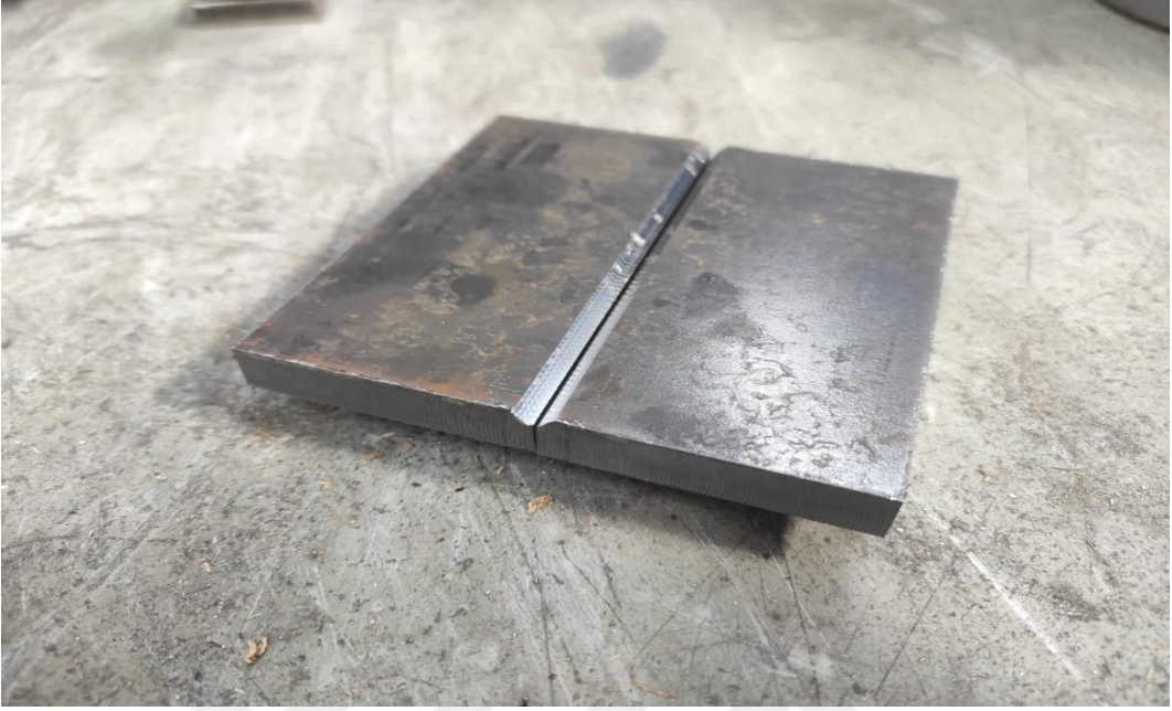
Şekil 6-2: 45° Açılışla Kaynak Ağzı Açılan Numunelerin Birleştirme Pozisyonu
