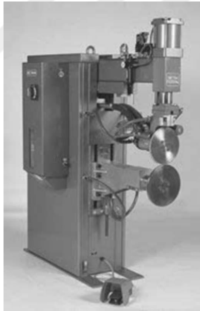
Şekil 1-6:Bakır tekerlek elektrotlarını gösteren tipik direnç dikiş kaynağı
