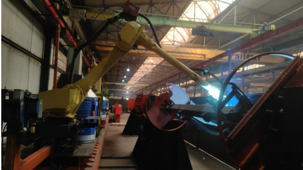
Şekil 6-5 : Robotik Kaynak Makinasının Fabrika İçinde Seri Kaynaklı İmalat Aşaması
