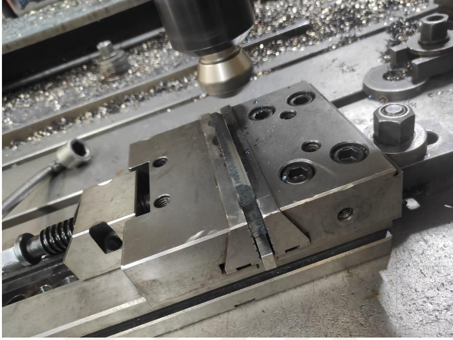
Şekil 5-1:CNC Tezgâhında Numuneye 45° Açı İle Kaynak Ağzı Açılması
