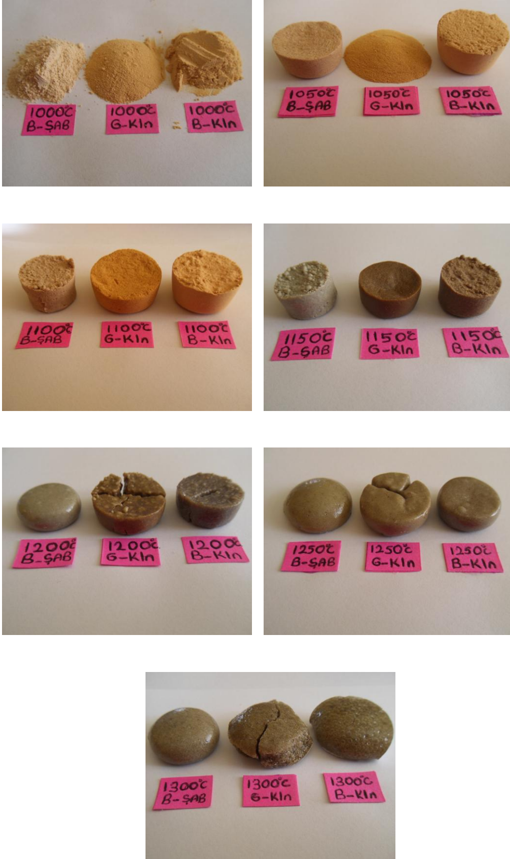
Şekil 7.7 Doğal numunelerin (B-Şab:Bala şabazit; B-Kln: Bigadiç klinoptilolit; G-Kln: Gördes Klinoptilolit) 1000-1300 °C arasında ısı uygulamasından sonraki görüntüleri
