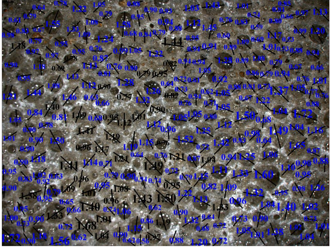
Şekil 7.28 Bigadiç Klinoptilolit+03 gözenek çap dağılımı (Ölçü: mm) (Büyütme: x 1)
