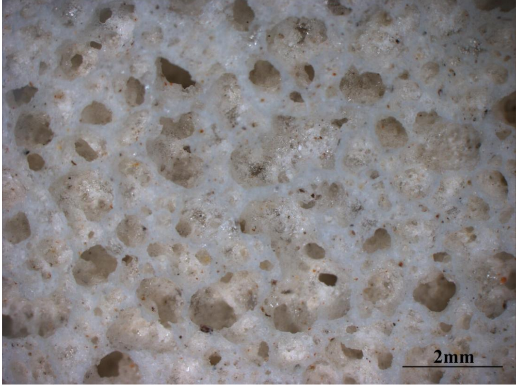
Şekil 7.20 Doğal Bigadiç Klinoptilolit + NaOH karışımından elde edilen gözenekli malzeme
