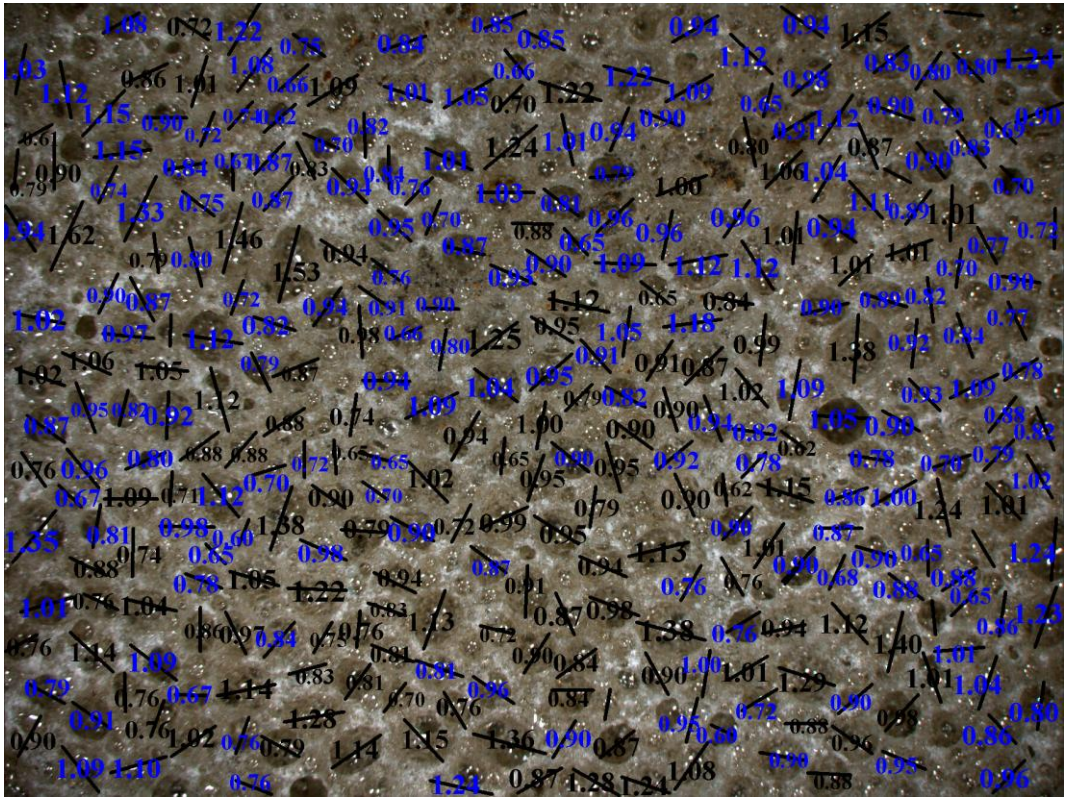
Şekil 7.43 Bigadiç Klinoptilolit+07 gözenek çap dağılımı (Ölçü: mm) (Büyütme: x 1)
